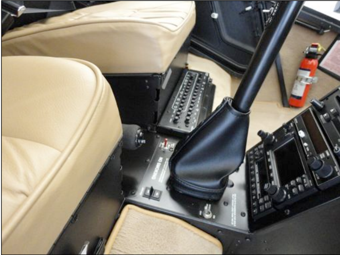
COLLECTIVE MIT STARTBUTTON UND N 2 GOVERNOR TRIM SWITCH
